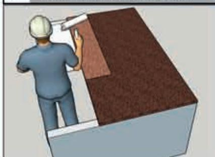
Para permitir la pre-expansión de la placa y evitar dilataciones posteriores, es fundamental humectar los tableros entre 18 y 24 hs antes su instalación. Aplique 1 litro de agua en la cara posterior rugosa, distribuyéndola con esponja, rodillo o pincel en forma homogénea en toda la superficie. **Seque por completo la cara decorada**, si fuera necesario.
