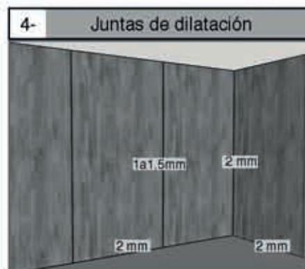
Cualquiera sea el método de colocación, para prever una futura dilatación del material, deje una luz de 2mm en
